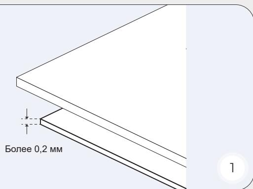
7.2.1. Перед началом монтажа напольного покрытия на основание необходимо уложить полиэтиленовую пленку толщиной не менее 200 мкм (0,2 мм)
