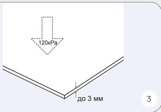
7.2.3. Перед началом монтажа напольного покрытия необходимо уложить специализированную подложку высокой плотности (прочность на сдавливание не менее 120 кПа, толщина до 3мм). Такая подложка служит звукоизоляционным и амортизирующим слоем между основанием и ламинатом.
