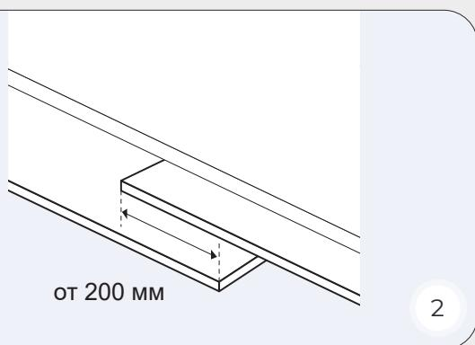
7.2.2. Края пленки заводятся на стены (после укладки ламината пленка скрывается под плинтусом, выступающие наружу излишки срезаются ножом). Полосы полиэтилена укладываются внахлест. Края полос должны перекрываться не менее чем на 200 мм
