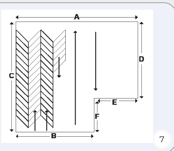
7.2.9. Последующие ряды. Теперь уложите ряд левых панелей. Начните от стены А и двигайтесь в направлении стены В. Всегда соединяйте под углом продольные стороны и соединяйте осторожным постукиванием короткие стороны панелей, используя накладку. Затем установите ряд правых панелей, начиная от стены В и двигаясь в направлении стены А.
