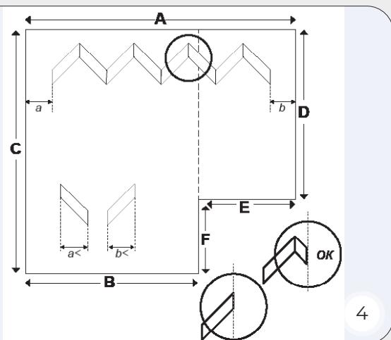
7.2.7. Уложите один ряд вдоль самой длинной стены «елочкой». Уложите этот ряд так, чтобы концы панелей находились на одном расстоянии у стены. Измерьте расстояния  $a$  и  $b$ . Не забудьте отнять 1 см (зазор на расширение покрытия). В идеальном случае расстояния  $a$  и  $b$  должны быть одинаковы. Если расстояние вдоль стены  $F$  окажется слишком малым, ищите оптимальный вариант. Начертите начальную линию вдоль стены  $C$ .
