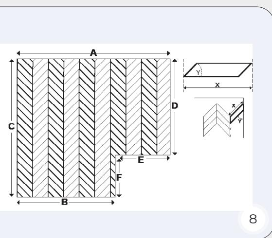
7.2.9. Окончание укладки. На окончательном этапе уложите недостающие панели вдоль стены D. Для укладки панелей у стены используйте уголок.
