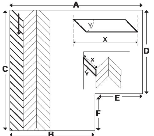
7.2.8. Теперь закончите укладку части пола, оставшейся между первым рядом и стеной С. Для этого ведите укладку от стены А в направлении стены В. Измерьте расстояние до стены (минимум 1 см) под зазор на расширение, а также угол, который необходимо отпилить, убедитесь в том, что ряд уложен напротив стены С и дополнительные блоки на своих местах.
