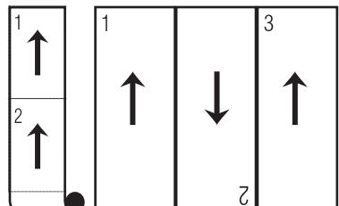
Метод встречной наклейки — каждое из последующих полотен переворачивается относительно предыдущего. Обои, требующие такого способа наклеивания, обозначаются специальным знаком на этикетке рулона.
