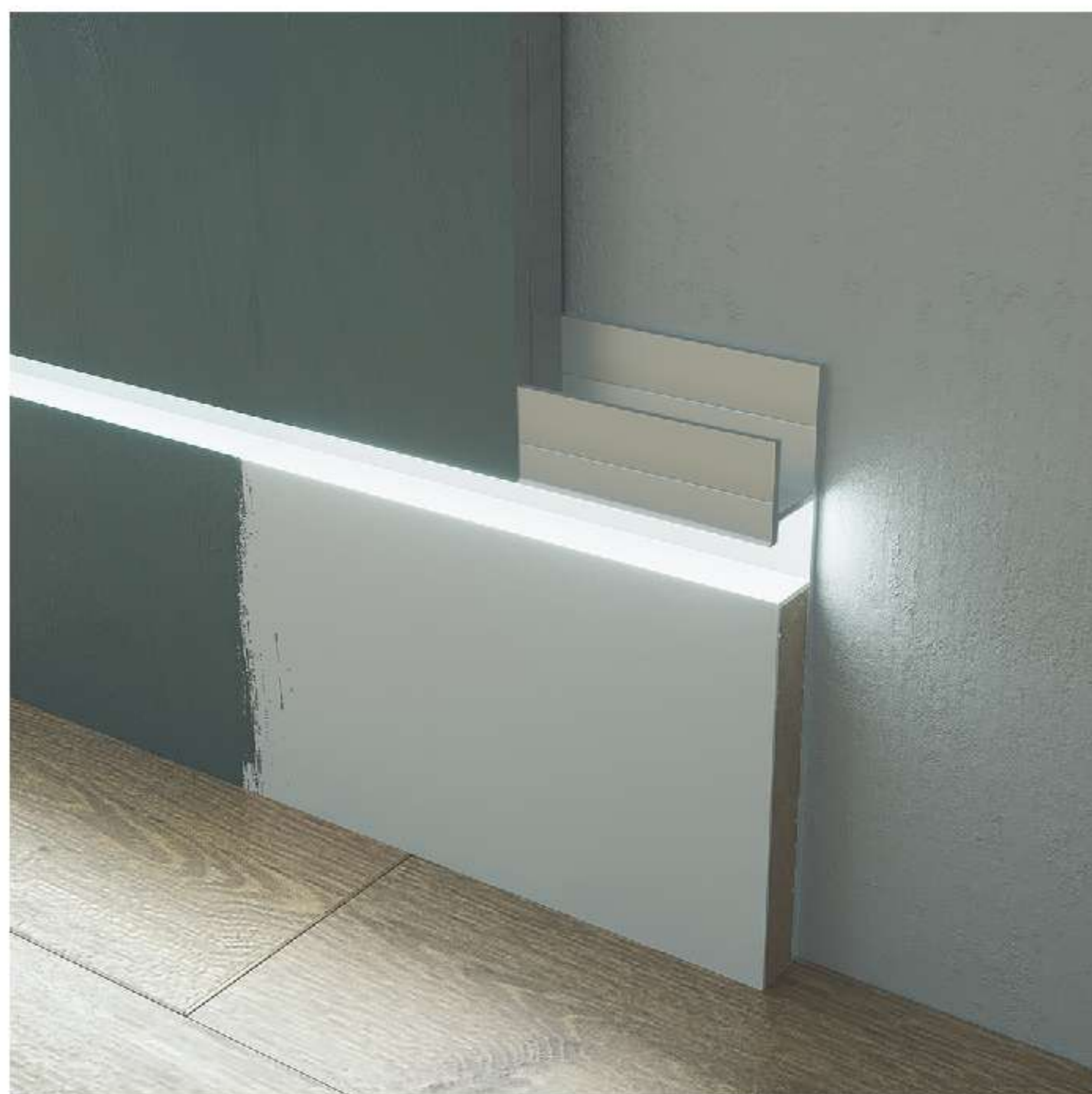
Скрытый плинтус с МДФ вставкой высотой 70 мм. под ГКЛ 9 мм. и стеновые панели со светодиодной лентой.
