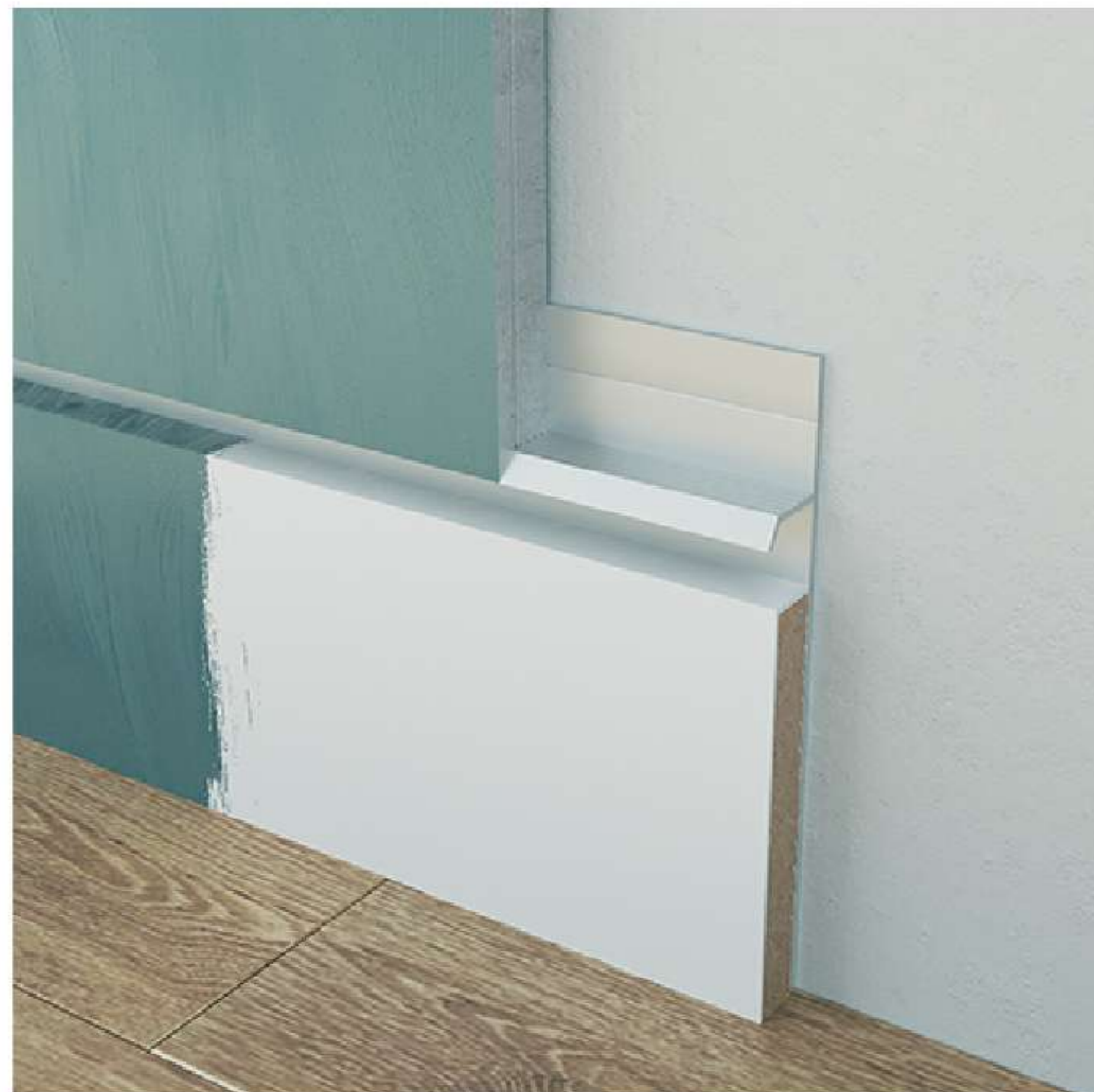
Скрытый плинтус с МДФ вставкой высотой 70 мм. под ГКЛ 12,5 мм. (возможна комплектация светодиодной лентой)
