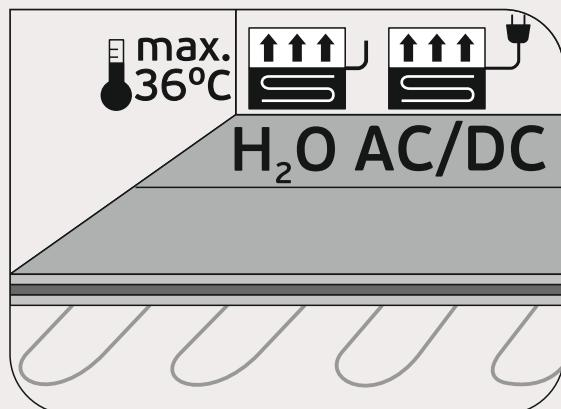
**Важно!** Температура поверхности пола с покрытием должна соответствовать требованиям СП 60.13330 и не превышать +36°C на поверхности покрытия. При укладке способом приклеивания к основанию **ОБЯЗАТЕЛЬНО** учитывать рекомендации производителя клея к температуре нагревания поверхности пола.
