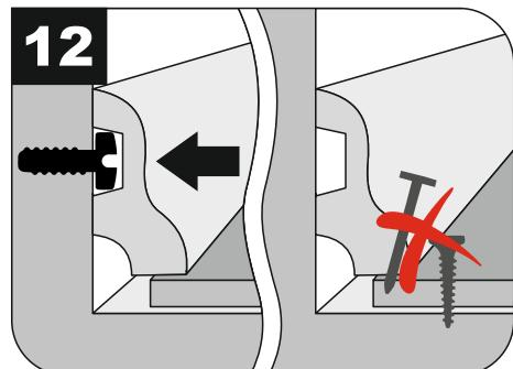
**7.4.10** Иногда при монтаже пола возникает ситуация невозможности установки плашки из-за помехи.
