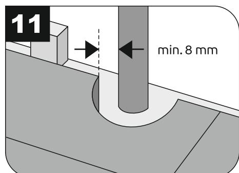
**7.4.9** Плинтус крепится к стене. Следите за тем, чтобы плинтус не был жёстко закреплён на поверхности кварцевого ламината — это может привести к деформации покрытия.
