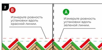
Установите А-образные плашки, как показано на рисунке. Тщательно проверьте стык между плашкой А и треугольником. Не должно быть никаких выступающих краёв и зазоров! Отрежьте левый край так, чтобы он соответствовал размеру помещения с учетом зазора для расширения 8 мм.
