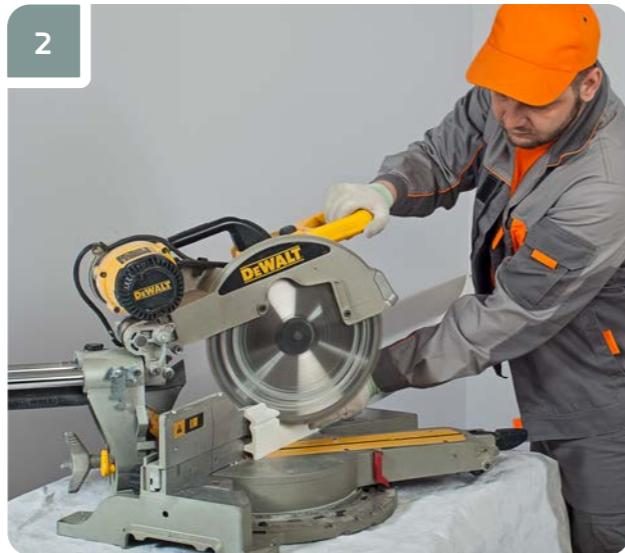
Выставить угол на торцовочной пиле, произвести запил изделия. В помещениях с углами, равными  $90^\circ$ , возможно использование стусла и ножовки.
