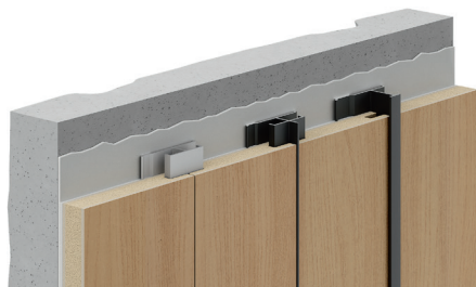
Прямая стыковка панелей с помощью соединительных профилей D1180 / D1181 / D1182
