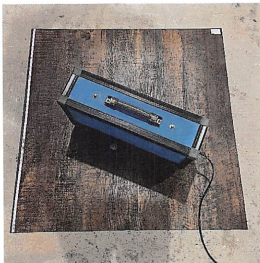
Фото 1. Одно из мест установки ударной машины
