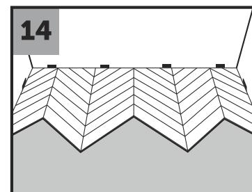
9.2 Соедините между собой отрезанные, в соответствии с предыдущим пунктом, панели так, чтобы получить стартовые треугольники. Монтаж треугольников начинайте один за другим слева направо (рис. 11).
