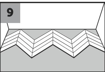
8. Продолжайте укладку второго, третьего и четвертого рядов, следуя описанным выше рекомендациям. По завершении монтажа четвертого ряда, перейдите к монтажу стартовых треугольников (рис. 8-9).
