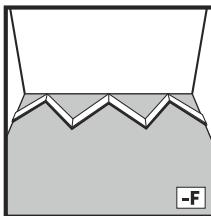
5. Замерьте и подрежьте завершающие панели ряда, оставив необходимые технологические зазоры от боковых стен (не менее 7 мм) (рис. 5А-5F).
