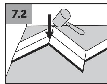
6. Укладку второго ряда следует начинать с первой полноразмерной панели А (подложка серого цвета). Заведите шип замка длинной стороны панели А второго ряда в паз замка длинной стороны панели А первого ряда под углом к основанию пола, почувствуйте стыковку и опустите панель А второго ряда на плоскость пола, чтобы зафиксировать замок (рис. 6).
