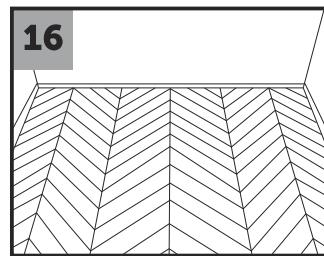
14. По завершению монтажа, удалите распорные клинья и закройте технологические зазоры плинтусом или любым декоративным молдингом, по Вашему выбору.
