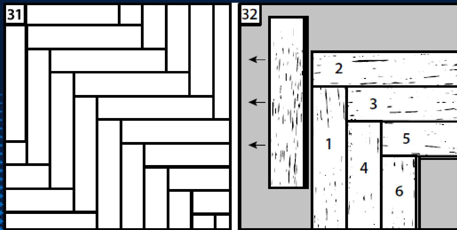
Порядок укладки досок параллельным узором
