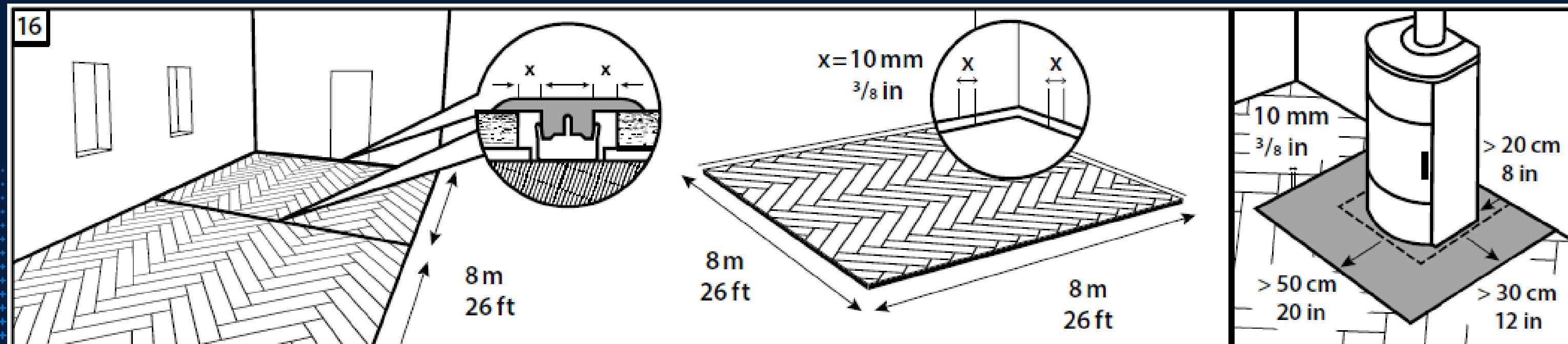
Пол вокруг каминной печи следует защитить от падающих углей с помощью искрогасителя. Для этого необходимо обеспечить искрозащиту на расстоянии не менее 50 см спереди и не менее 30 см по бокам камеры сгорания.
