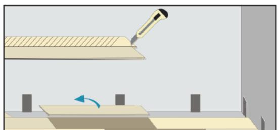
15 После завершения укладки ламината, установите плинтус для закрытия расширительного зазора и придания законченного вида помещению
