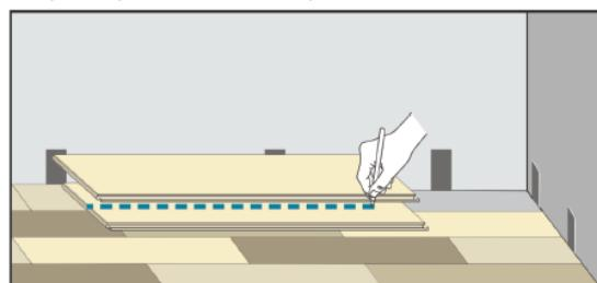
14 Подрежьте планку, учитывая расширительный зазор. Закончите подрезку и укладку последнего ряда аналогично
