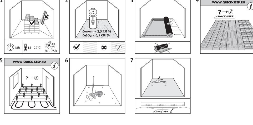
1. Обязательно дайте панелям возможность отлежаться в течение 48 часов в закрытой упаковке, расположив их в центре того помещения, где предполагается укладка напольного покрытия. Обязательным условием укладки является температура воздуха 15 - 22° С и относительная влажность воздуха в пределах 30-75 %.
