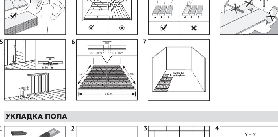
1. Перед началом работы и в процессе укладки пола проверяйте цветовой оттенок всех панелей только при дневном свете. Ни в коем случае следует использовать для укладки поврежденные панели.
